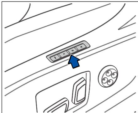
Сиденье обладает функцией "поясничной опоры". Если нажать кнопку "1", верхняя часть поясничной опоры медленно приподнимется и расширится. Если отпустить кнопку, приподнятие остановится. Если нажать кнопку "2", нижняя часть поясничной опоры медленно приподнимется и расширится и если отпустить кнопку, приподнятие остановится.
