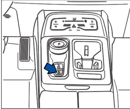
Функция AUTO HOLD автоматически включает стояночный тормоз после парковки, без нажатия водителем педали тормоза или рычага стояночного тормоза. Как только система обнаружит, что автомобиль больше не движется, AUTO HOLD запускается немедленно и стабилизирует автомобиль. В это время индикатор на комбинации **AUTO HOLD** приборов мигает, чтобы напомнить водителю, что работает функция AUTO
