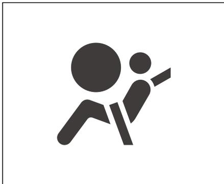
Контрольная лампа подушки безопасности контролирует состояние системы подушек безопасности, цепь системы предварительного натяжения ремня и все связанные цепи. Когда пусковой выключатель находится в положении ON, система сначала выполняет самопроверку, и сигнальная лампа подушки безопасности загорается на несколько секунд, а затем гаснет, указывая на то, что система находится в исправном рабочем состоянии. При
