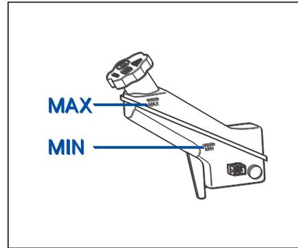
Регулярно проверяйте тормозную жидкость в баке тормозной жидкости. Уровень жидкости всегда должен быть между отметками MAX (максимум) и MIN (минимум). Во время движения из-за износа и автоматической регулировки тормозных накладок уровень жидкости немного снизится, что является нормой.
