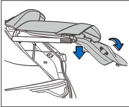
Потяните за ручку или за край багажника вниз. Как только будет достигнут необходимый угол, дверь закроется с помощью электропривода.
