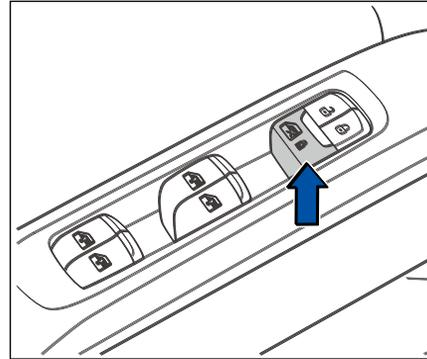
Некоторые модели оснащены переключателем замка для детской безопасности на панели переключателей левой передней двери. При нажатии этого переключателя электрический замок задней двери для детской безопасности будет заблокирован, и пассажиры не смогут использовать переключатель стеклоподъемника, а заднюю дверь нельзя будет открыть изнутри автомобиля. Нажмите этот переключатель еще раз, и замок для
