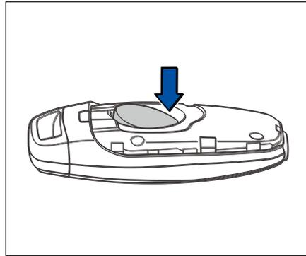
3. Извлеките батарею, нажав на перегородку батареи пальцем или отверткой.
