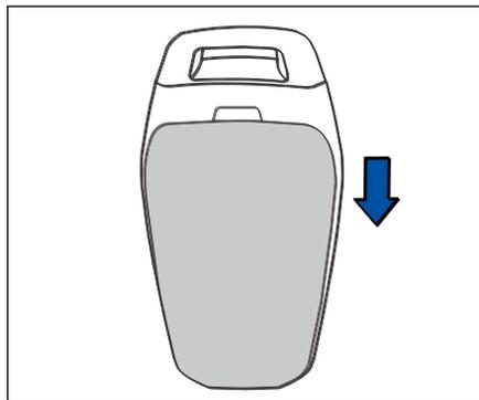
1. Нажмите на заднюю крышку отсека батареи, сдвиньте ее по стрелке и снимите.
