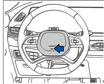
Клаксон будет работать независимо от положения пускового переключателя, при условии, что 12 В батарея не разрядится. При нажатии на клаксон, раздастся звуковой сигнал. Отпустите клаксон и звуковой сигнал перестанет звучать.
