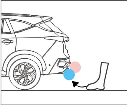
3. Плавно махните ногой рядом с рабочим диапазоном заднего бампера (примерное расстояние - 50мм-100мм), не касаясь заднего бампера;
