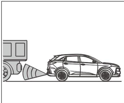
3. Датчик реверсивного радара не может обнаружить автомобиль с высоким шасси.
