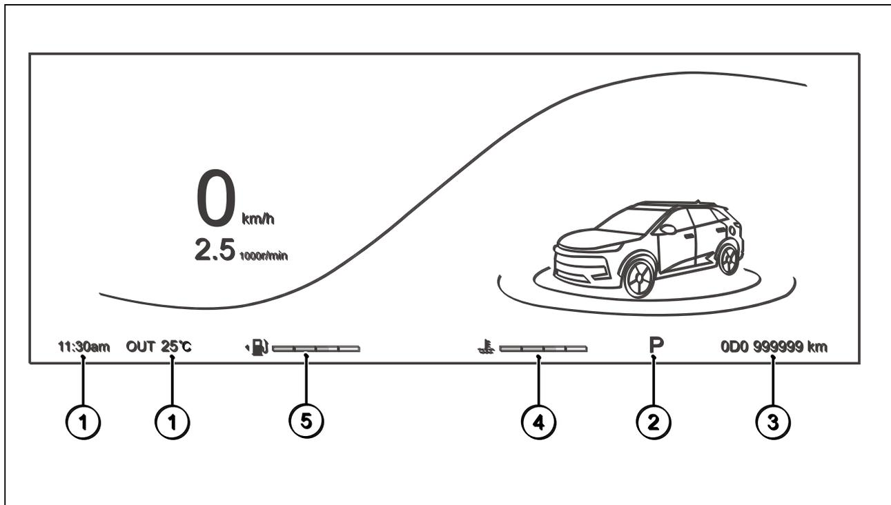
① **Время/Температура:** постоянно отображаемая информация. Время может отображаться в 12-часовом и 24-часовом режиме и обновляться синхронно со временем на MP5 после включения пускового переключателя.
