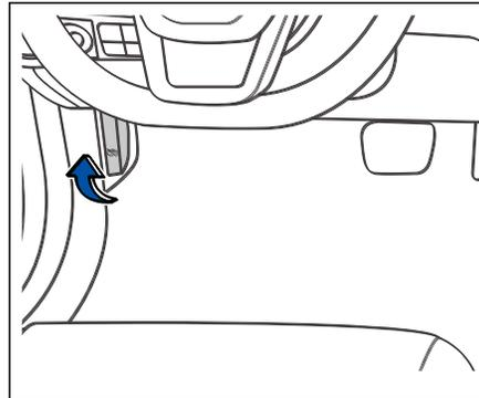
1. Дважды потяните за ручку открытия капота и капот приоткроется;
