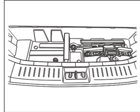
1. Откройте багажник и снимите покрытие пола.
