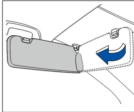
Для защиты от боковых бликов, снимите солнцезащитный козырек с центрального крепления и поверните его в сторону. Откройте козырек и сдвиньте крышку, чтобы открыть зеркало в козырьке. Если автомобиль оснащен лампой освещения зеркала, лампа автоматически загорится при открытии крышки зеркала; и автоматически выключится при закрытии.
