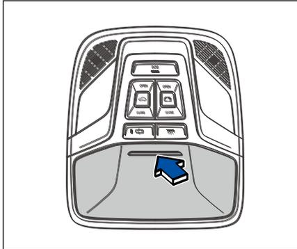
Ящик для очков расположен на потолочной консоли. Нажмите на верхнюю часть крышки, чтобы открыть ящик для очков.
