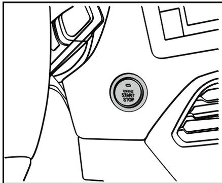
Когда смарт-ключ находится в зоне обнаружения автомобиля, водителю не нужно вынимать ключ из кармана или сумки, для запуска нажмите кнопку пускового выключателя. Перед включением пускового кнопочного выключателя автоматическая коробка передач должна находиться в положении P, а механическая коробка передач должна быть в нейтральном положении.
