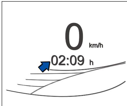
Данный прибор показывает ВРЕМЯ автомобиля в пути после последнего сброса значения. При проверке двигателя время в пути суммируется. При остановке работы двигателя, отчет времени останавливается. Время вождения автоматически сбрасывается после полного выключения комбинированного прибора.
