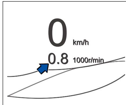
Двигатель быстрее изнашивается и потребляет больше топлива, если во время движения частота оборотов двигателя слишком высока. В большинстве случаев двигатель экономит больше топлива при работе на низких оборотах.
