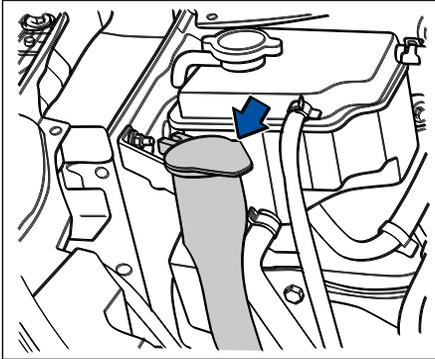
Всегда проверяйте уровень жидкости в очистителе лобового стекла. Если чистящей жидкости недостаточно, пополняйте ее вовремя. Чистящая жидкость может замерзнуть и расширяться в холодном климате. Не допускайте, чтобы уровень жидкости превышал три четверти после наполнения, в противном случае резервуар для жидкости для очистки лобового стекла может быть поврежден. Для лучшей очистки жидкость можно
