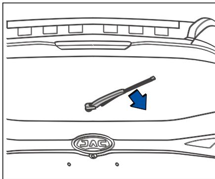
1. Поднимите рычаг стеклоочистителя и слегка вытяните щетку в направлении стрелки.
