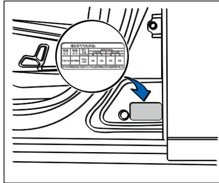
Этикетка с указанием давления в шинах прикреплена к двери водителя, и на ней можно увидеть размер шин и давление в шинах в холодном состоянии. Рекомендуемое давление в холодном состоянии, указанное на этой этикетке, представляет собой минимальное давление в шинах, необходимое для поддержки максимальной грузоподъемности автомобиля.
