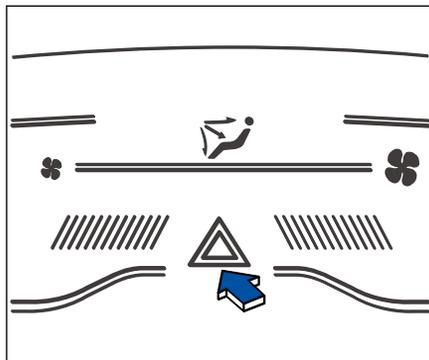
На выключателе лампы аварийной сигнализации есть треугольная метка, как показано на рисунке. Лампа аварийной сигнализации будет мигать, пока не разрядится аккумуляторная батарея 12В. Если вам необходимо остановиться или припарковаться в аварийной ситуации, включите лампу аварийной
