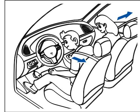
Если ваш автомобиль оборудован устройством предварительного натяжения ремня безопасности, в некоторых случаях при столкновении система предварительного натяжения ремня безопасности может быть активирована с помощью системы подушек безопасности. Система предварительного натяжения ремня безопасности работает с механизмом, втягивающим ремень безопасности, чтобы помочь вам и вашим пассажирам немедленно пристегнуть ремень
