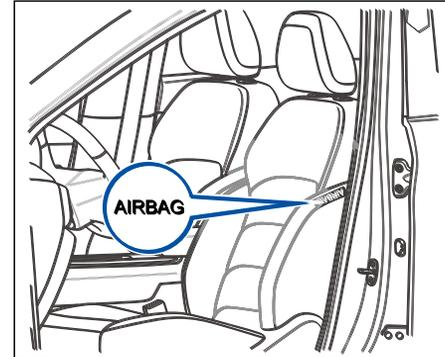
Боковая подушка безопасности установлена на сиденье водителя и на задней части сиденья переднего пассажира, и к ней прикреплена табличка «AIRBAG», указывающая ее местоположение. Когда происходит боковое столкновение, система активирует боковую подушку безопасности со стороны столкновения, и подушка безопасности мгновенно раскрывается с высокой скоростью, обеспечивая защиту пассажиров на стороне столкновения.
