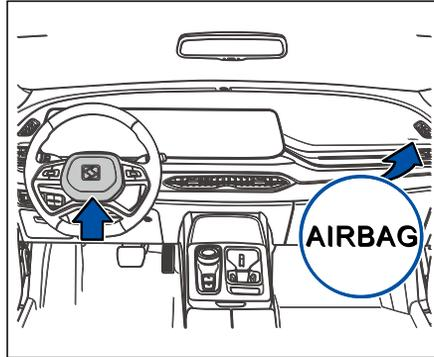
Подушка безопасности расположена в центре рулевого колеса. Фронтальная подушка безопасности пассажира расположена на приборной панели. На нем есть знак «AIRBAG». В случае сильного лобового удара подушка безопасности переднего сиденья раскрывается, она также может раскрыться при воздействии других форм удара, аналогичных сильному лобовому удару.
