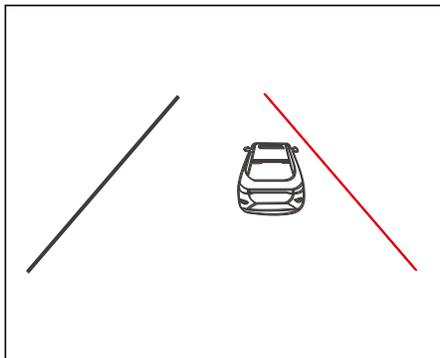
Интерфейс предупреждения модуля комбинации приборов показан на рисунке выше. Когда система слежения за дорожной разметкой обнаруживает, что автомобиль отклоняется от полосы движения, модуль комбинации приборов показывает интерфейс предупреждения и посылает звуковой сигнал предупреждения о выходе из полосы движения.
