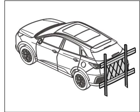
1. Датчик реверсивного радара не может обнаружить железный провод, кабель, блочную сеть и другие сети.
