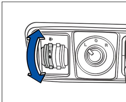
Когда пусковой переключатель находится в положении ВКЛ и фара включена, водитель может регулировать угол наклона оптической оси фары с помощью кнопки регулировки высоты фары. В зависимости от нагрузки транспортного средства и условий вождения, регулировка фары в правильном положении может улучшить видимость, не ослепляя встречное движение.
