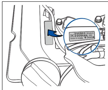
Заводская табличка двигателя расположена на верхней стороне капота.
