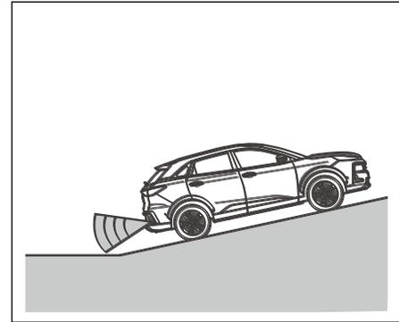
2. Если автомобиль находится на крутом склоне, система реверсивного радар может ошибочно сработать.
