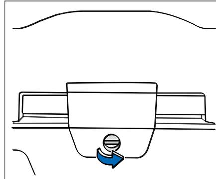
Треугольная предупредительная табличка размещена на задней откидной двери. Чтобы вынуть треугольную предупредительную табличку, сначала поверните ручку крышки треугольной предупредительной таблички против часовой стрелки (90°), откройте крышку треугольной предупредительной таблички. Установите треугольную предупредительную табличку в крышку треугольной
