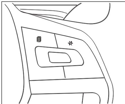
Клавиши управления на руле можно использовать для управления многофункциональным информационным дисплеем.
