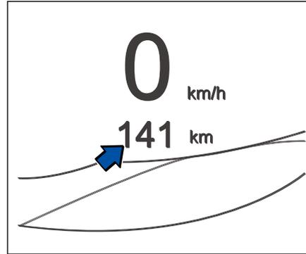
Диапазон используется для отображения пробега с текущим показателем топлива в баке. Значение среднего расхода топлива рассчитывается исходя из расхода топлива в минуту. Следовательно, учитывая различные дорожные условия и условия вождения, отображаемый расход может измениться как в положительную, так и в отрицательную сторону, что отличается от фактического расстояния поездки. Это значение приводится только для
