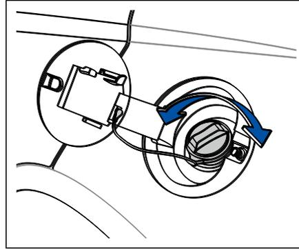
1. Когда автомобиль разблокирован, нажмите на крышку топливного бака и она автоматически откроется.
