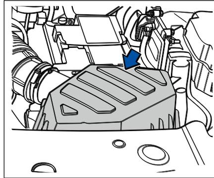
Воздушный фильтр можно чистить при проверке элемента воздушного фильтра. Заменяйте фильтрующий элемент в соответствии с интервалом времени, указанным в руководстве по техническому обслуживанию. Если автомобиль движется в пыльных или песчаных условиях, заменяйте фильтрующий элемент чаще, чем рекомендуется. Этапы замены фильтрующего элемента:
