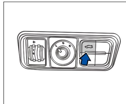
Когда пусковой переключатель находится в положении ON, нажмите и удерживайте переключатель, чтобы закрыть заднюю откидную дверь.
