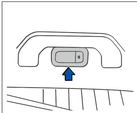
Лампы на двери находятся на обеих стенках. Для включения и выключения нажмите на кнопку. Когда переключатель передней потолочной лампочки включен, лампа на двери загорается при открытии любой двери.
