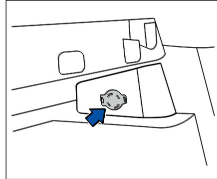
Некоторые модели оборудованы розетками в багажном отделении. Дополнительное устройство может заряжаться от этой розетки. Перед использованием, пожалуйста поднимите защитную крышку. Если розетка не используется, не забудьте закрыть ее защитной крышкой.
